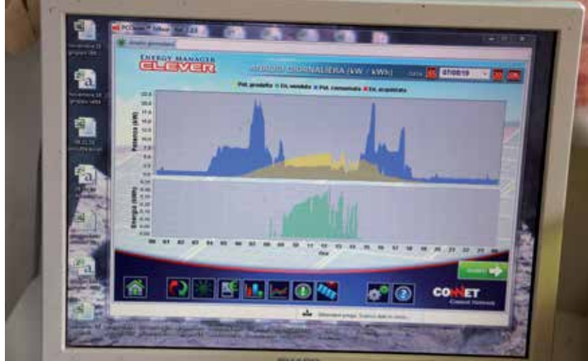
ECCO LA SCHERMATA DEL SOFTWARE CHE MONITORA LA PERFORMANCE DELL'IMPIANTO FOTOVOLTAICO COLLOCATO SUL TETTO DELLA SALA DI MUNGITURA. I RASCHIATORI E IL SEPARATORE DELLE DEIEZIONI VENGONO ATTIVATI AUTOMATICAMENTE SOLTANTO QUANDO È CONVENIENTE DAL PUNTO DI VISTA ECONOMICO
